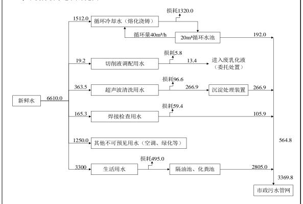
图 2-1 本项目水平衡分析示意图 (m³/a)
