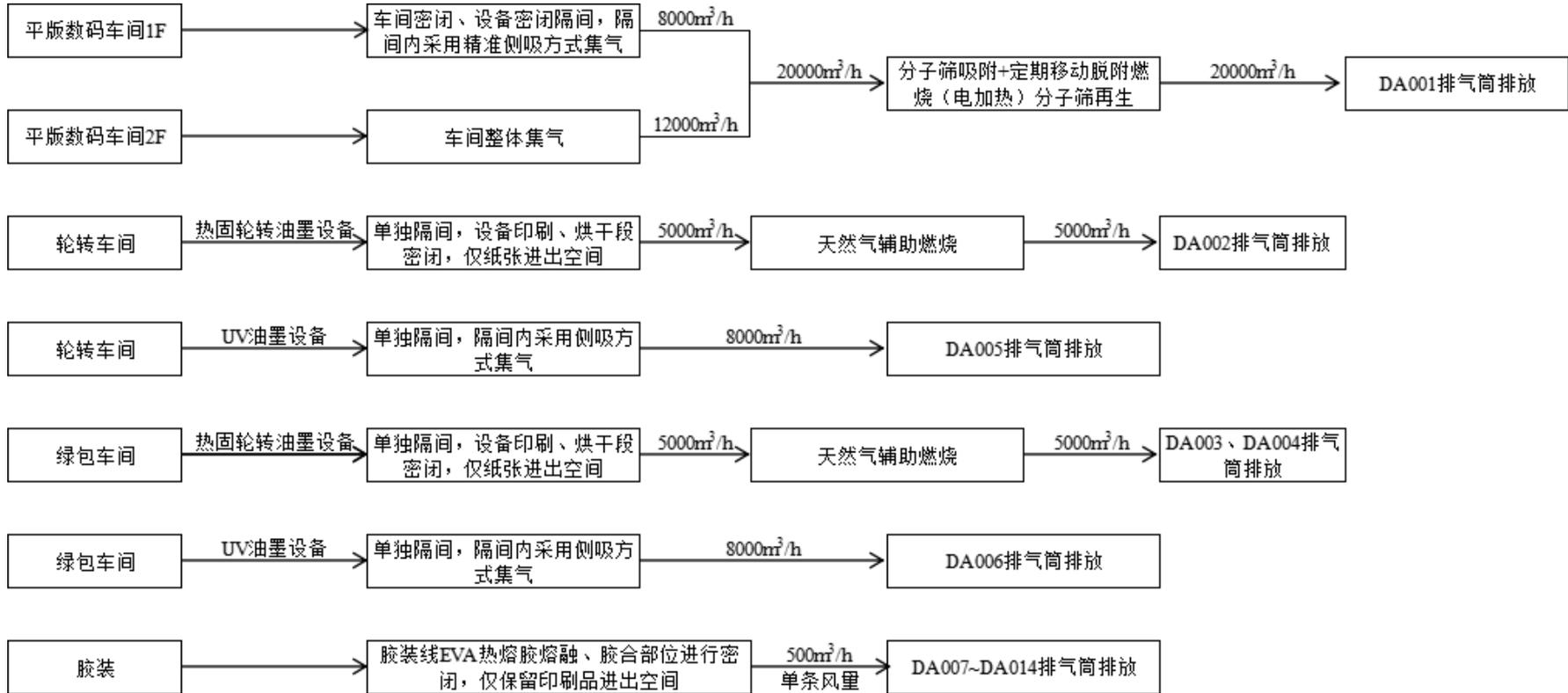
图4-1 废气收集、处理和排放流向示意图
